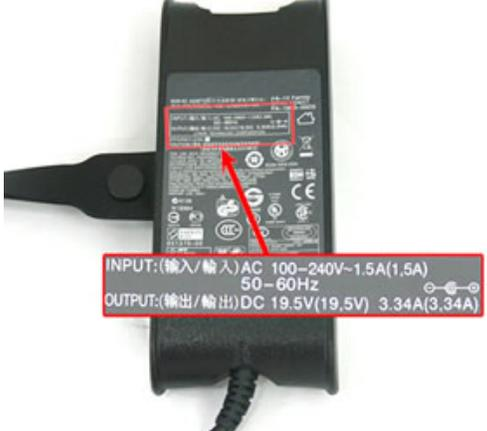
INPUT:(输入/输入) AC 100-240V-1.5A(1.5A)
